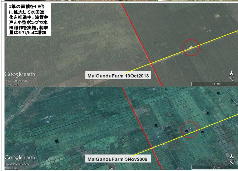
図8. Kebbi州のArugungu付近の氾濫原のMai Gandu農場(表9のMGD Farm 20haの一部、位置は図4と5)における水田の改良(進化)の進行を示すGoogle衛星写真。下は2009年で1筆面積15-25m<sup>2</sup>の浅管井戸でポンプ灌漑の小区画水田。収量は2-3t/ha。2011年3月よりアフリカ水田農法で耕耘機等を使用して1筆面積を4-9倍に拡張し、畔を強化、代掻きと均平化のレベルも改良中。図9の写真は2014年6月に赤丸の付近で撮影。収量は6-7t/haに増加。
