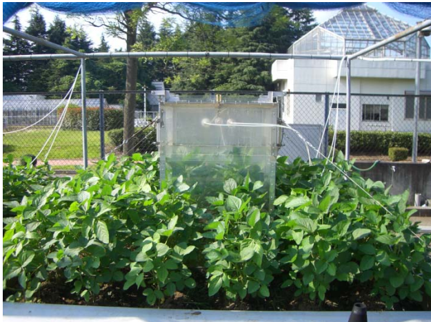
図2：農耕地から発生する温室効果ガスの自動連続測定風景
